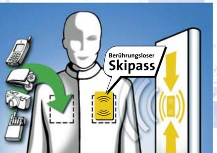
Die Key-Card ist im Scheckkartenformat und mit einem kleinen Chip versehen. Sie tragen die Karte auf der linken Körperseite und können berührungslos und schneller das Drehkreuz passieren.
